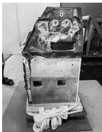
図9 鉛板を剥がした状態
