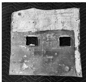
図10 左の面から剥がした鉛板の内側
