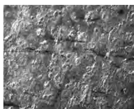
図9 ニス層の下にある 特徴的なクラック
