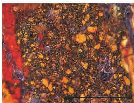
写真33 緑漆の細粒 (×40), スケール1.0mm
