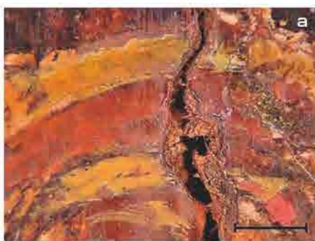
写真32 木目塗盆, 見込亀裂部 (×10)
